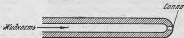
Рис. 6. Схема прямоструйной форсунки
